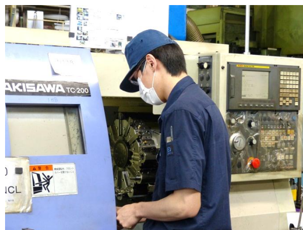
NC旋盤の工具の取り付けも検定試験の重要なポイントで、複数の加工で相互の干渉が無いようセットする
